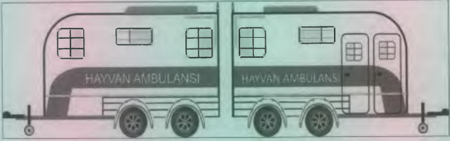
Şekil 3. Hayvan ambulansı olarak tasarlanan bir römorkun dış görünüşü.
