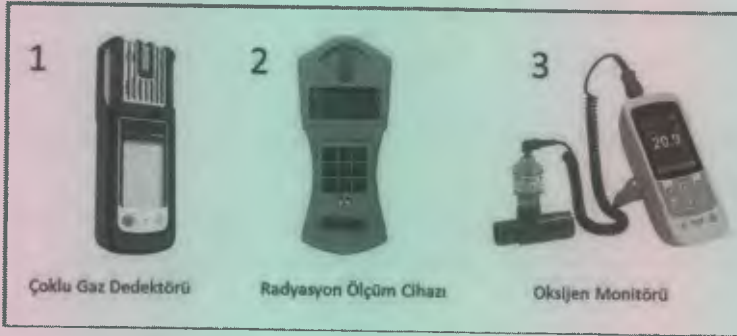
Resim 10. Kurtarma Operasyonlarında Kullanılan Çeşitli Detektörler
